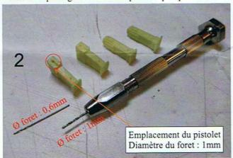
L'emplacement des tuyaux se percent avec un foret de 0,6mm. Se référer au pré-trou sur le champ de chaque pompe, côté pistolet.
